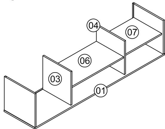
Fixe as peças 03 e 04 na peça 01 com cavilha 06 x 30 e parafuso 5,0 x 40 Flangeado. Depois fixe as peças 06 e 07 com cavilha 06 x 30 e parafuso 5,0 x 40 Flangeado
