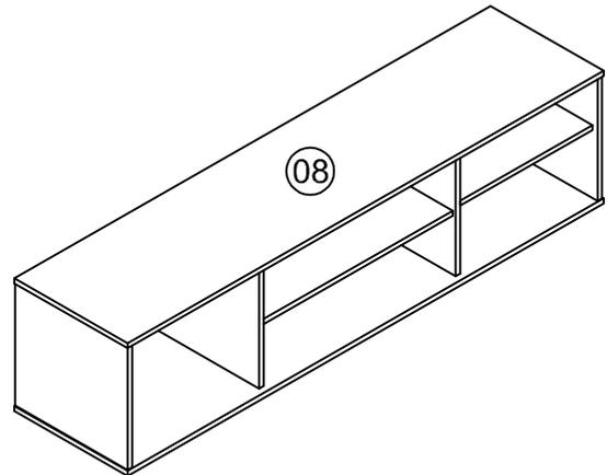
Encaixe o fundo 11 no rasgo do tampo 08 e fixe nas peças 02,03,04 e 05 com mini-fix 15 x 12.
