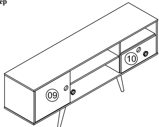
Fixe as dobradiças nas porta com parafuso 3,5 x 14 Flangeado. Depois fixe a porta 09 na lateral e a porta 10 na base com parafuso 3,5 x 14 Flangeado. Depois encaixe os puxadores nos furos das portas.
