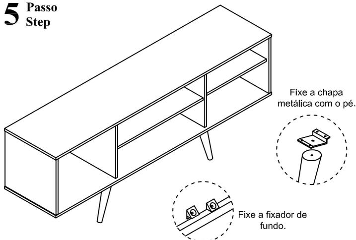
Fixe o pé na chapa metálica com parafuso 5,0 x 40 Flangeado. Depois fixe a chapa na base com parafuso 3,5 x 14 Flangeado. Por ultimo, fixe os fixadores de fundo com parafuso 3,5 x 12 chato.
